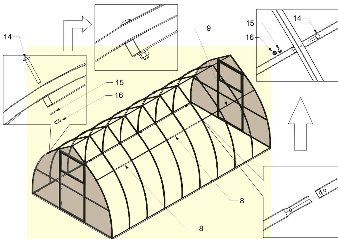
4. Выставьте основания и нижние трубы фронтонов горизонтально с помощью строительного уровня. Проверьте диагонали теплицы. Через проушины основания вбейте колышки в землю. Колышки после окончательной установки теплицы закрепить к каркасу саморезами. Скрепите дуги с основаниями т коньковыми перемычками.
