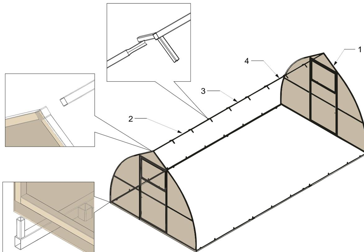
На основания установите полудуги с шагом 0,66 м на пальцы основания. Вставляйте полудугу сначала в верхний палец, затем в нижний на основании.
