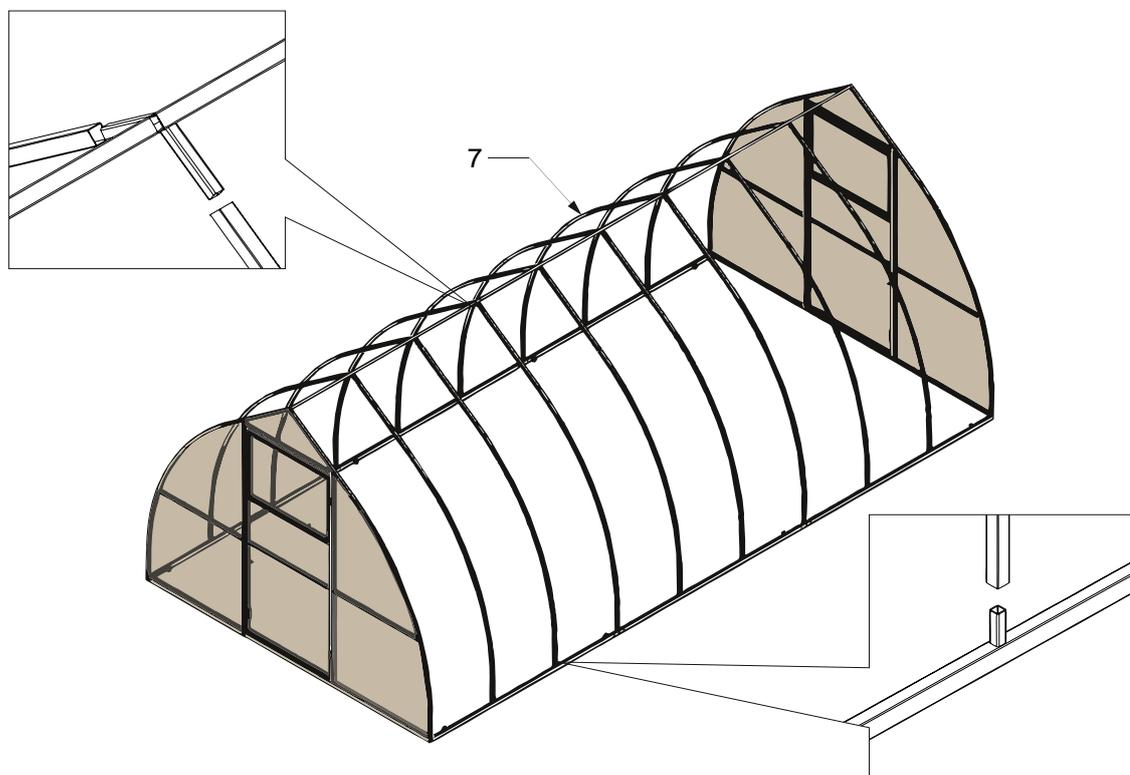
Стяните дуги перемычками, закрепив их болтами на дугах.
