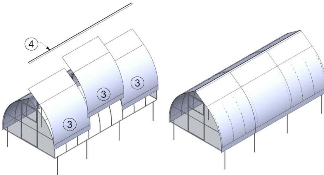
Сотовый поликарбонат устанавливается строго определенной стороной наружу (к солнцу), имеющей защитный слой от ультрафиолета. Эта сторона покрыта пленкой с рисунком или имеет синий оттенок, а противоположная сторона покрыта только прозрачной пленкой. Упаковочную пленку необходимо удалить перед установкой на каркас.
