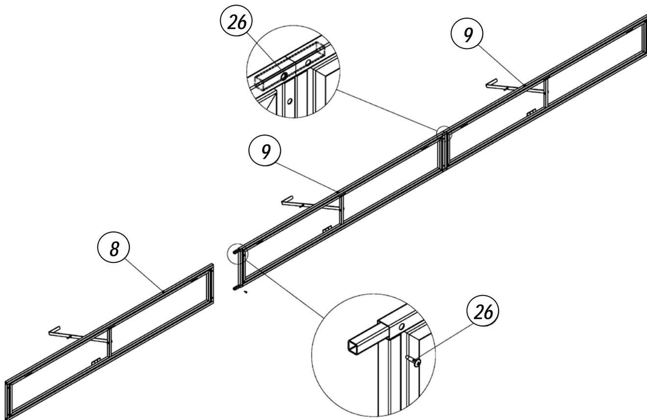
Рис.4 Схема установки форточек
