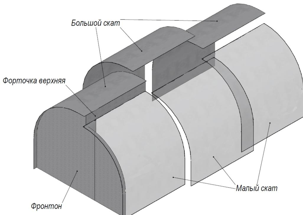
Рис.3 Схема укрытия поликарбоната
