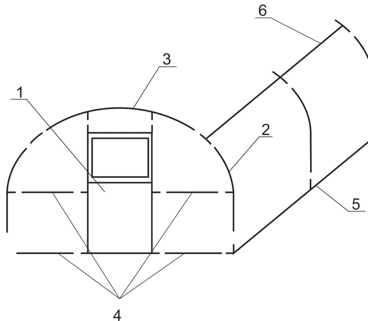
Произвести сборку остальных дуг. Последовательно при помощи продольных средних и нижних элементов соединения (5 и 6).
